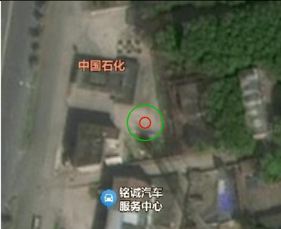
图 5-1 密闭卸油口小孔泄漏池火灾事故后果模拟图
