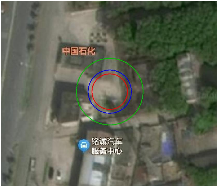
图 5-2 密闭卸油口中孔泄漏、完全破裂池火灾事故后果模拟图
