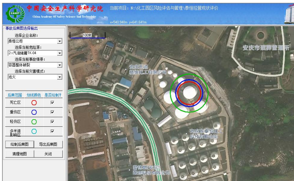
图 4-5 国 VI 汽油储罐 TK-04 容器整体破裂池火灾事故影响范围
