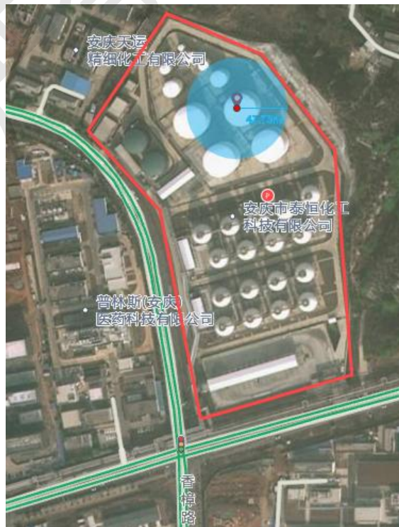
图 4-4 轻油罐组国 VI 汽油储罐 TK-04 容器中孔泄露池火灾事故多米诺效应半径
