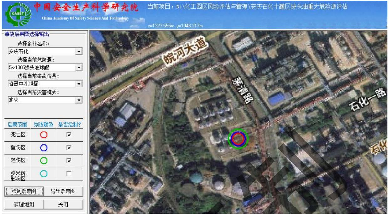
图 5-2 容器中孔泄漏-池火灾模拟结果图
