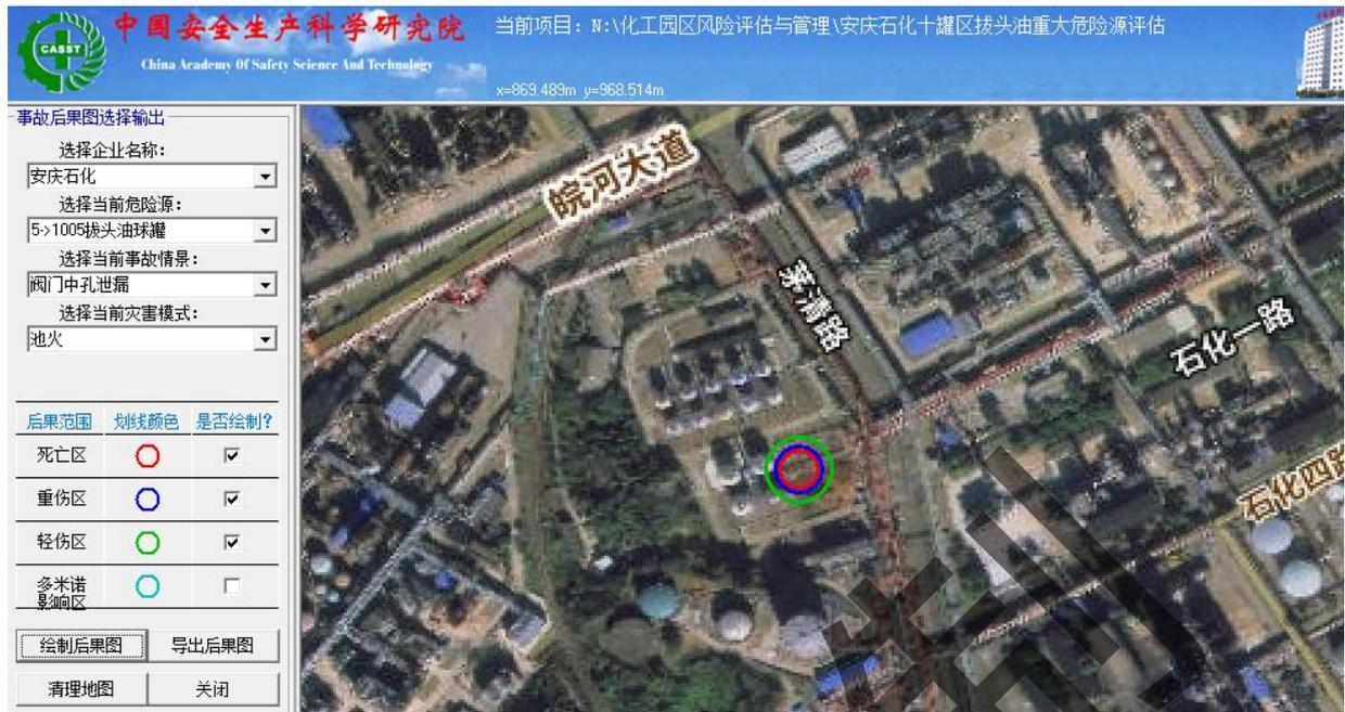
图 5-4 阀门中孔泄漏-池火灾模拟结果图
