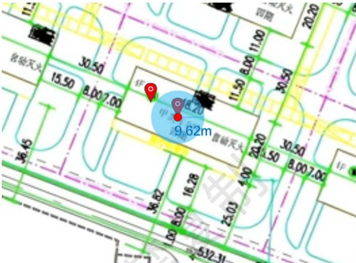
图 10-8 甲类车间 4 配料釜云爆事故多米诺效应模拟图
