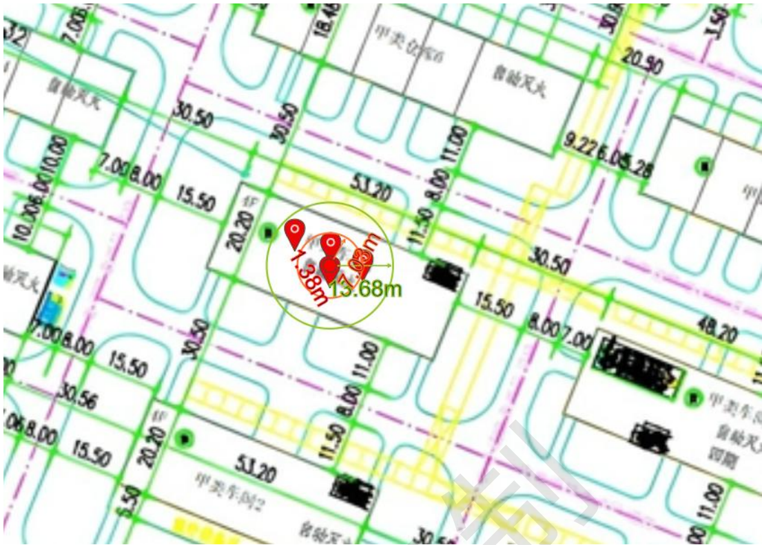
图 10-1 甲类车间 1 脱溶釜池火灾事故后果图
