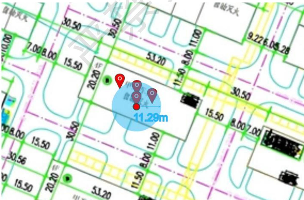
图 10-12 甲类车间 1 脱溶釜云爆事故多米诺效应模拟图
