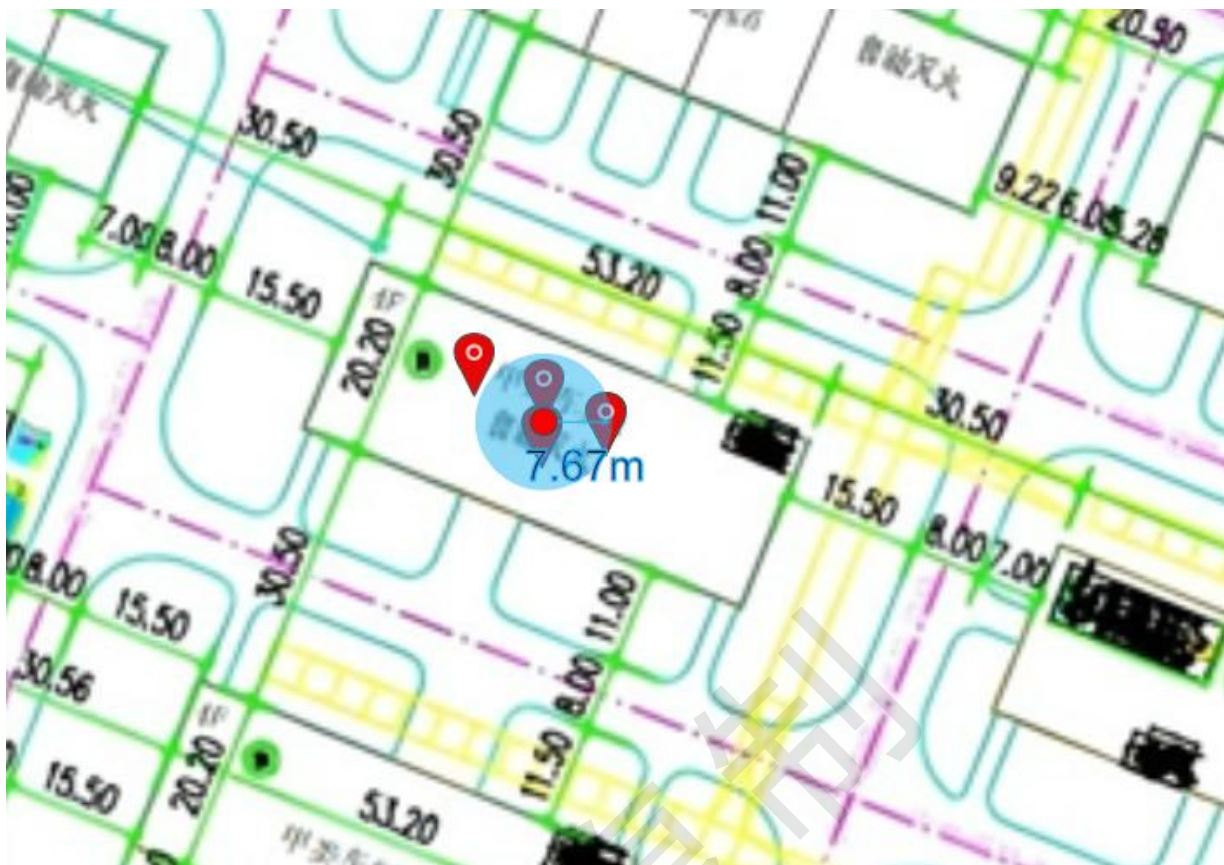
图 10-11 甲类车间 1 酯化釜云爆事故多米诺效应模拟图
